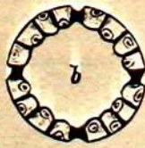
93. Konec dýmantového vrtadla; a) se strany, b) zdola.
